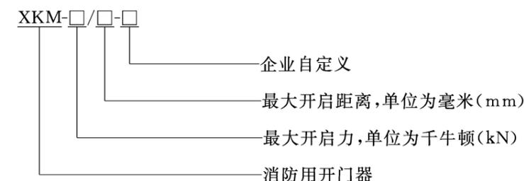
标记示例: XKM-80/100 表示最大开启力为 80 kN,最大开启距离为 100 mm 的消防用开门器。
